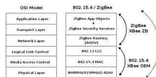
FIGURA 3.2: Modelo OSI y Zegbee mas 802.15.4
