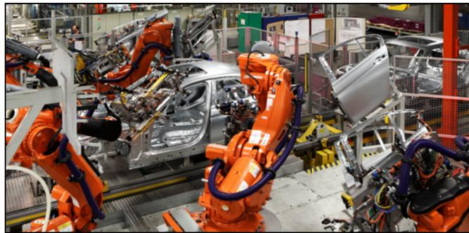
Figura 1.1. Montaje automatizado de puertas en un vehículo
