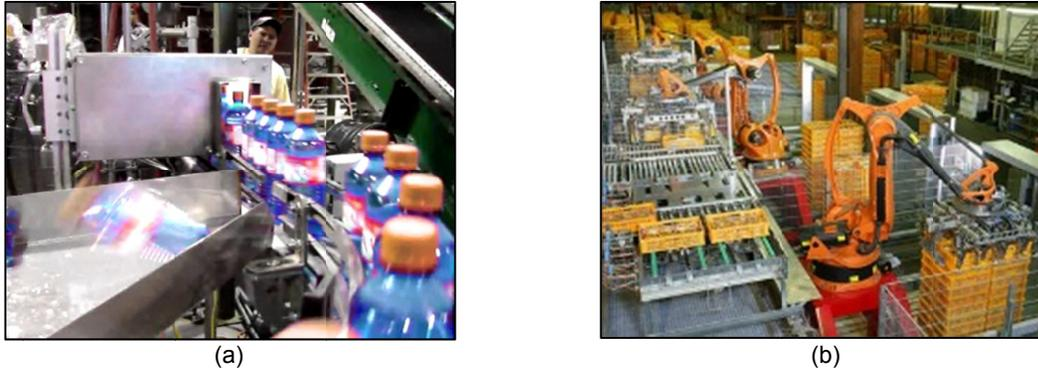
Figura 1.3. Aplicación Sensores de barrera. (a) Detección de fallas. (b) Presencia de Productos.
