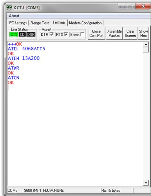
Figura C.5. Configuración mediante comandos AT.
