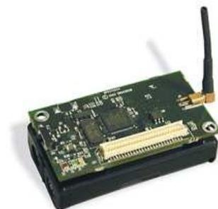
Figura 1.2: Sensor inalámbrico Crossbow MicaZ mote
